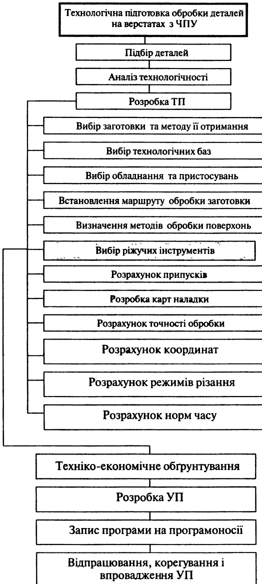
Рисунок 1.4. Схема технологічної підготовки обробки деталей на верстатах з ЧПУ
